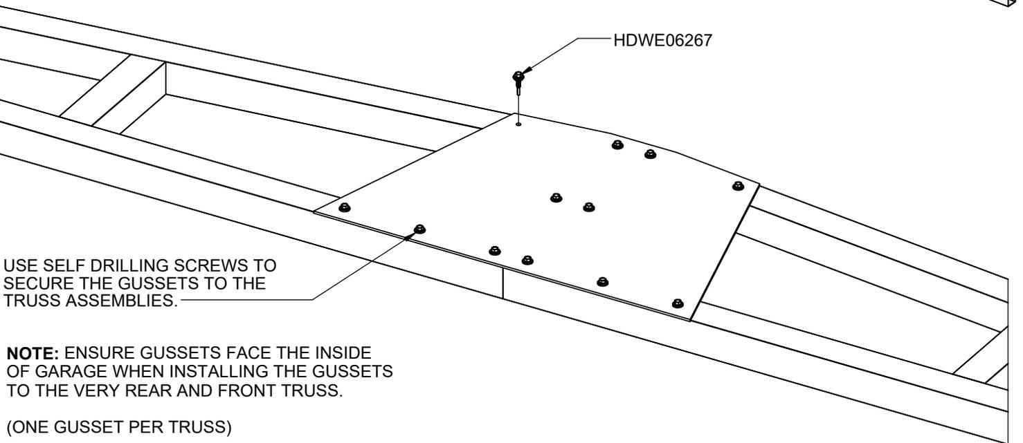
**NOTE:** ENSURE GUSSETS FACE THE INSIDE OF GARAGE WHEN INSTALLING THE GUSSETS TO THE VERY REAR AND FRONT TRUSS.
